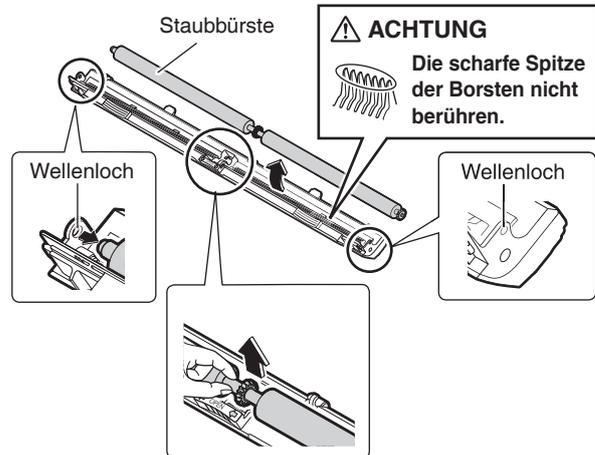
Stellen Sie sicher, dass die Staubbürste sicher befestigt ist. Andernfalls rotiert die Staubbürste möglicherweise nicht und der FILTERREINIGUNG-Betrieb kann gegebenenfalls nicht ausgeführt werden.
