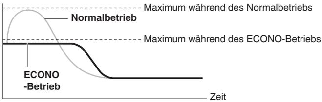
Das Maximum für den aktuellen Stromverbrauch und den Stromverbrauch der Klimaanlage im ECONO-Betrieb schwankt je nach zugeschaltetem Außengerät.
