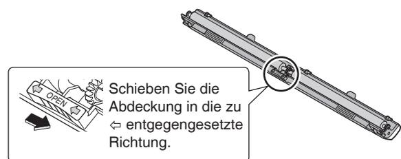
2. Halten Sie die Staubbox mit beiden Händen und bringen Sie sie im Gerät an, so dass die Staubbürste der Klimaanlage gegenüberliegt.
