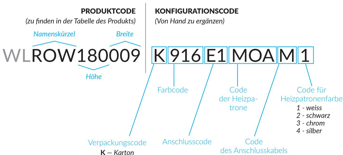
WL – Elektroheizkörper gefüllt mit Heizmedium und werksseitig eingebauter Heizpatrone
