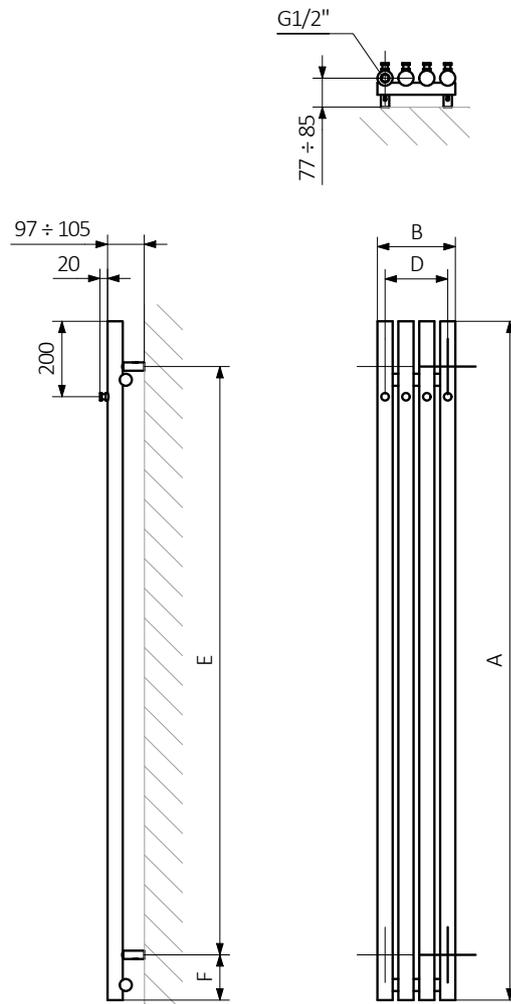
A – Höhe B – Breite D – horizontaler Wandhalterungsabstand E – Vertikaler Wandhalterungsabstand F – Abstand von der Achse der unteren Wandhalterung bis Unterkante des Kollektors
