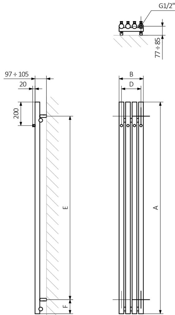
A – Höhe B – Breite D – horizontaler Wandhalterungsabstand E – Vertikaler Wandhalterungsabstand F – Abstand von der Achse der unteren Wandhalterung bis Unterkante des Kollektors
