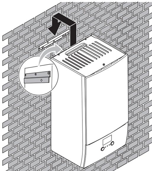
**4** Optional: Wenn Sie das Gerät über die Innenseite des Geräts an der Wand befestigen möchten:
