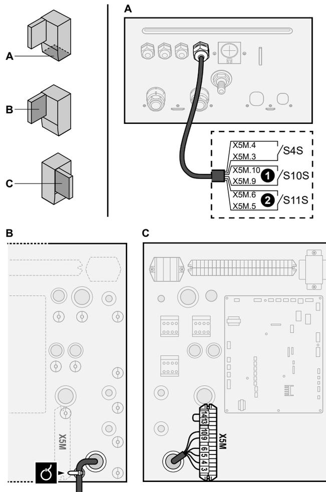
2 Fixieren Sie die Kabel mit Kabelbindern an den Kabelbinderhalterungen.
