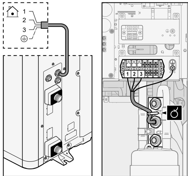
**3 (optional) Ablaufschlauchheizelement-Kabel:**
