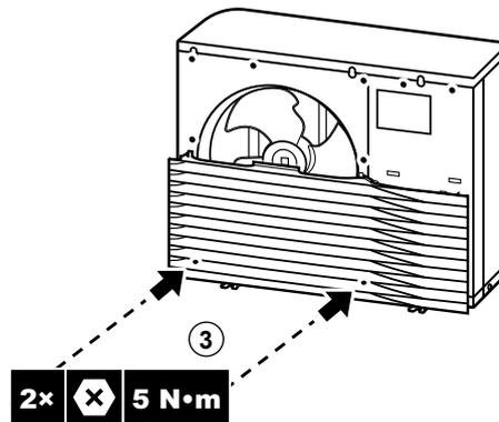
**Installieren Sie den oberen Teil des Auslassgitters**
