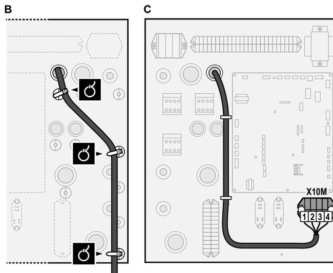
4 Fixieren Sie die Kabel mit Kabelbindern an den Kabelbinderhalterungen. Fixieren Sie bei Bedarf überschüssige Kabellänge mit einem Kabelbinder.
