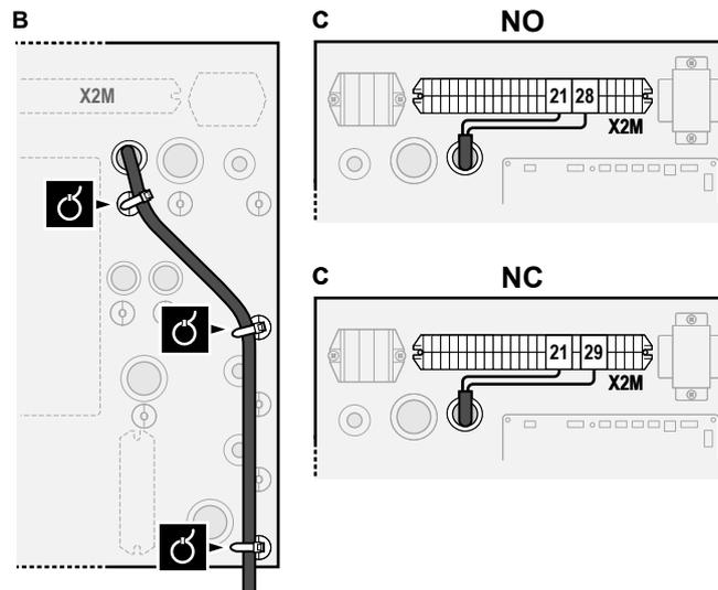
3 Befestigen Sie das Kabel mit Kabelbindern an den Kabelbinderhalterungen.
