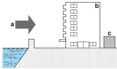
Installieren Sie eine Windschutzwand, wenn das Außengerät direktem Wind vom Meer ausgesetzt ist.
