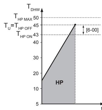
**HP** Wärmepumpe. Wenn die Aufwärmzeit durch die Wärmepumpe zu lange dauert, kann zusätzliche Erwärmung durch die Reserveheizung erfolgen.
