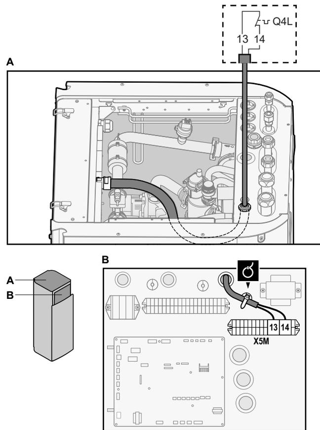
3 Das Kabel mit Kabelbindern an den Kabelbinderhalterungen befestigen.
