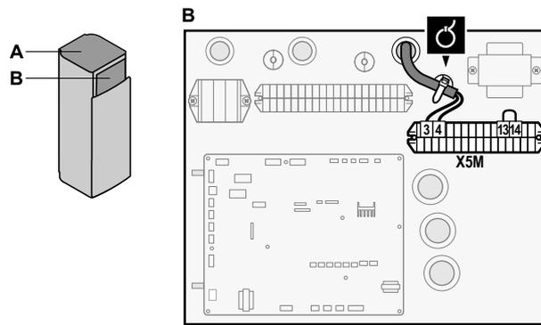
3 Schließen Sie die Hochspannungskabel wie folgt an:
