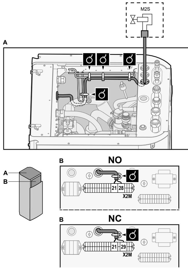
3 Das Kabel mit Kabelbindern an den Kabelbinderhalterungen befestigen.
