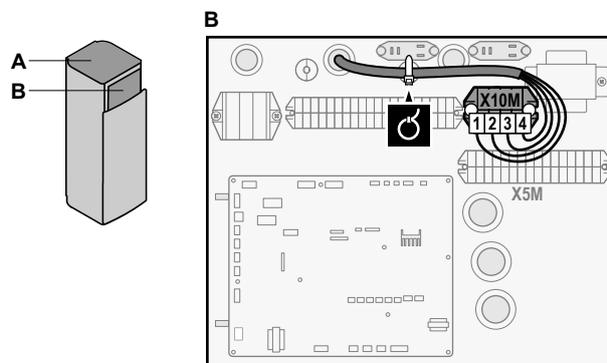
4 Fixieren Sie die Kabel mit Kabelbindern an den Kabelbinderhalterungen. Fixieren Sie bei Bedarf überschüssige Kabellänge mit einem Kabelbinder.
