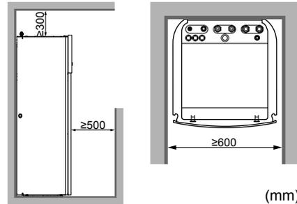
Zusätzlich zu den Vorgaben für die Abstände: Der Raum, in dem Sie das Innengerät aufstellen, muss auch den Bedingungen entsprechen, die unter ["7.1.5 Installationsmuster"](#) [▶ 70] beschrieben sind.
