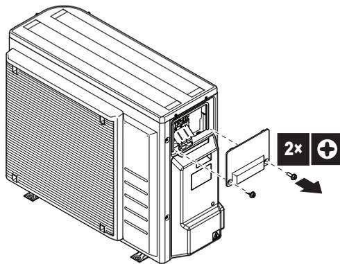
2 Entfernen Sie die Abdeckung der Kältemittelleitung.
