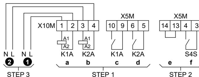
**STEP 1** Installation Smart Grid-Relaissatz
