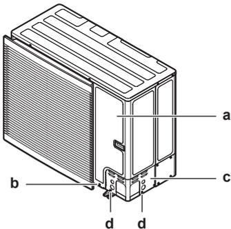
2 Wählen Sie eine Rohrleitungsführung aus (a, b, c oder d).
