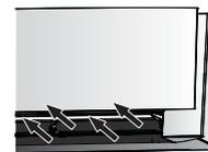
Die Luftstromrichtung wird so angepasst, dass die Luft entlang der Decke verteilt wird.
