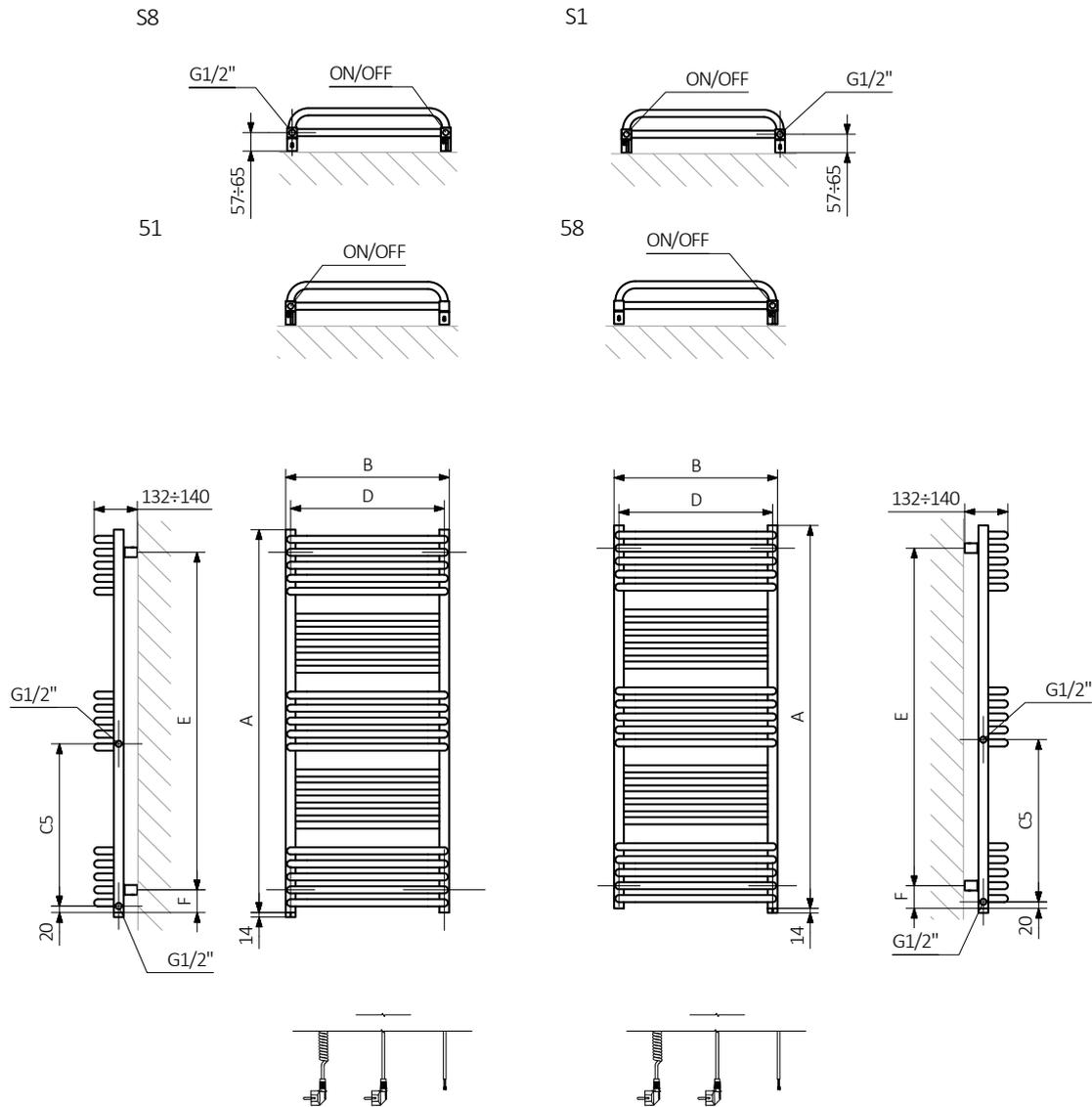
A – Höhe B – Breite C1-C5 – Anschlussabstand D – horizontaler Wandhalterungsabstand E – Vertikaler Wandhalterungsabstand F – Abstand von der Achse der unteren Wandhalterung bis Unterkante des Kollektors
