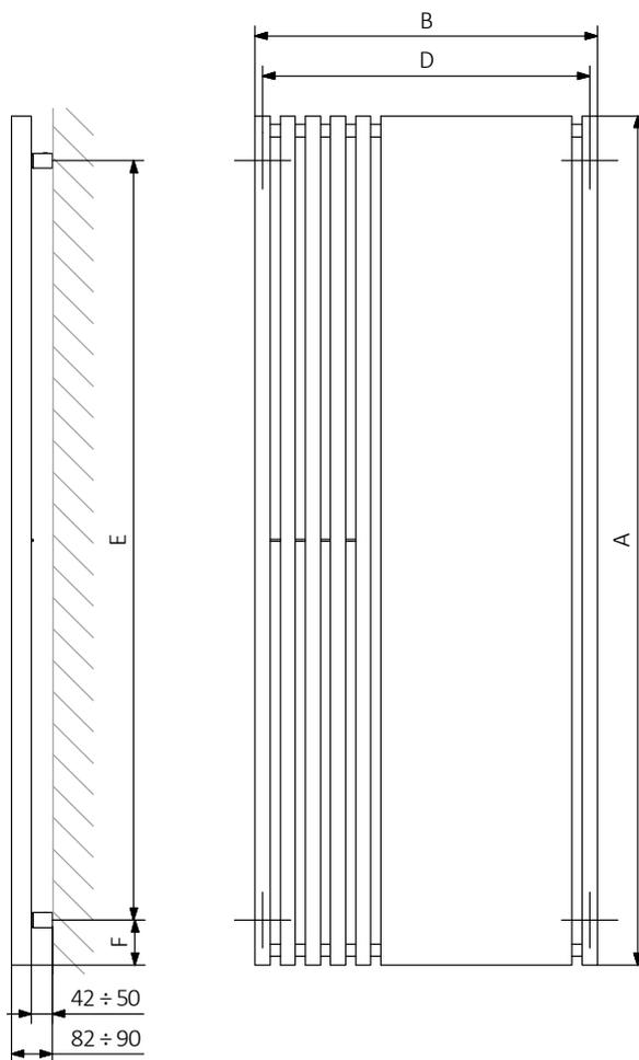
A – Höhe B – Breite C1-C5 – Anschlussabstand D – horizontaler Wandhalterungsabstand E – Vertikaler Wandhalterungsabstand F – Abstand von der Achse der unteren Wandhalterung bis Unterkante des Kollektors
