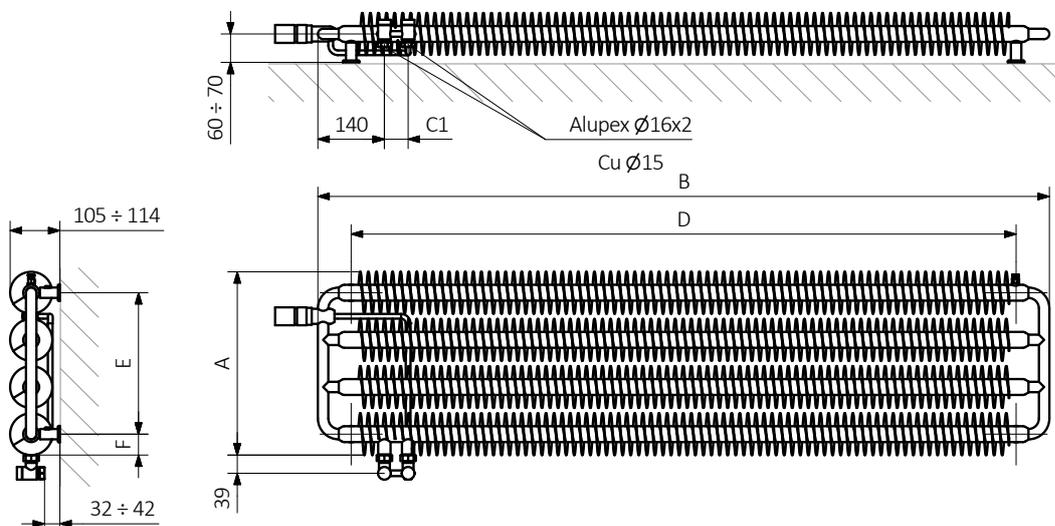
A – Höhe B – Breite C1-C5 – Anschlussabstand D – horizontaler Wandhalterungsabstand E – Vertikaler Wandhalterungsabstand F – Abstand von der Achse der unteren Wandhalterung bis Unterkante des Kollektors
