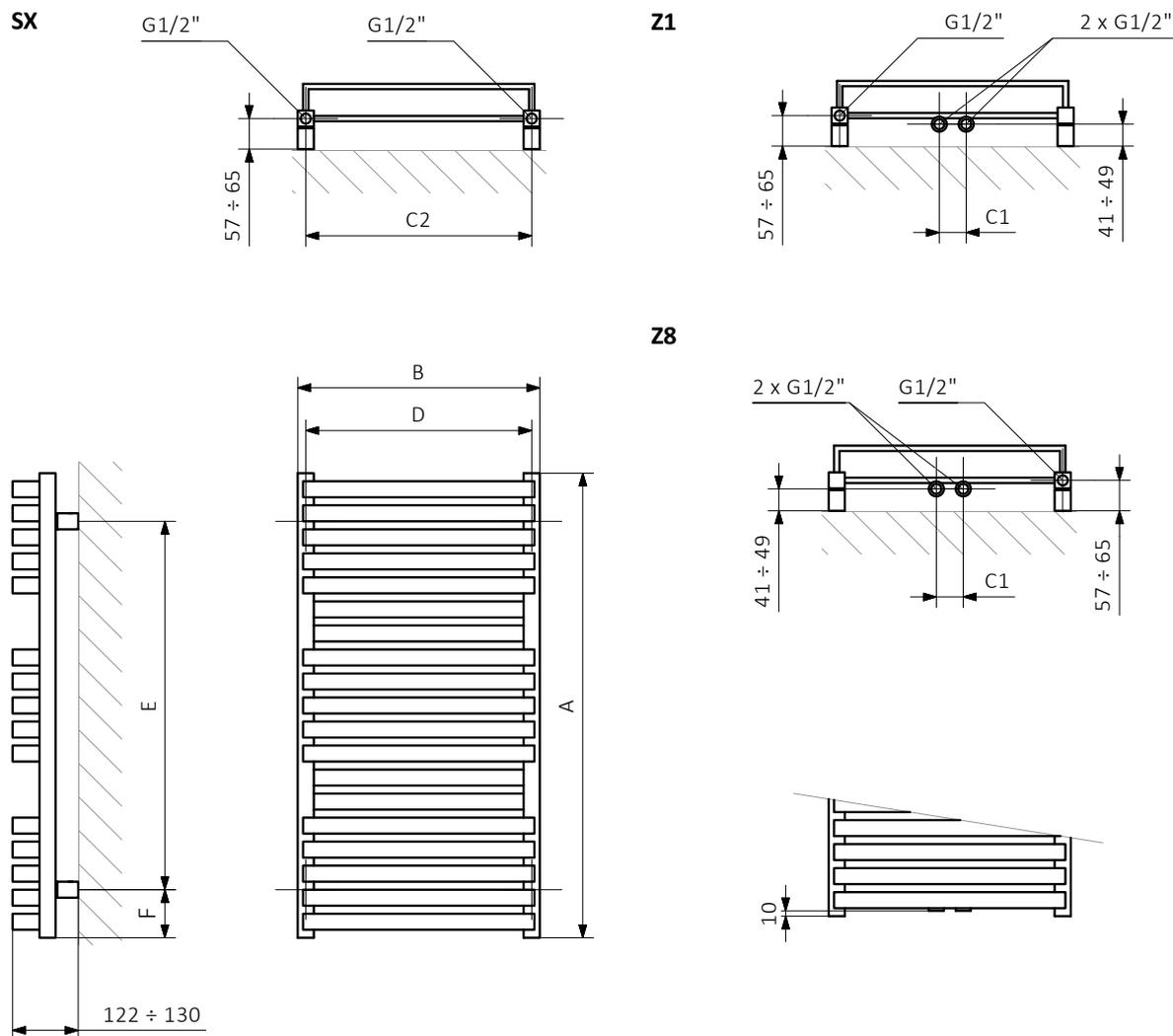
A – Höhe B – Breite C1-C5 – Anschlussabstand D – horizontaler Wandhalterungsabstand E – Vertikaler Wandhalterungsabstand F – Abstand von der Achse der unteren Wandhalterung bis Unterkante des Kollektors
