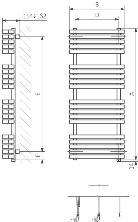
A – Höhe B – Breite C1-C5 – Anschlussabstand D – horizontaler Wandhalterungsabstand E – Vertikaler Wandhalterungsabstand F – Abstand von der Achse der unteren Wandhalterung bis Unterkante des Kollektors
