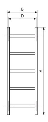
A – Höhe B – Breite C1-C5 – Anschlussabstand D – horizontaler Wandhalterungsabstand E – Vertikaler Wandhalterungsabstand F – Abstand von der Achse der unteren Wandhalterung bis Unterkante des Kollektors
